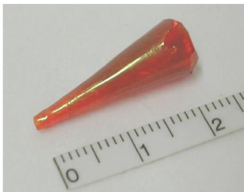
Рисунок 48. Кристаллы тетрацена, полученные методом Бриджмена.[249]
